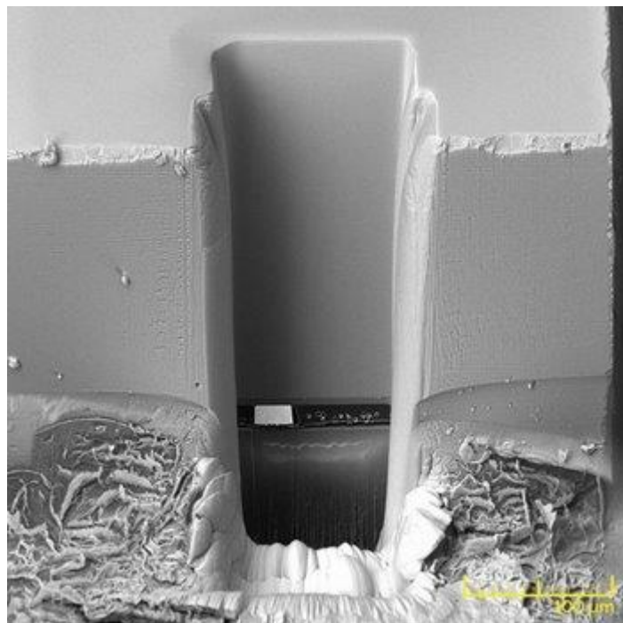
Rys. 2. Przekrój przez układ scalony wykonany z użyciem technologii Xe-PFIB
