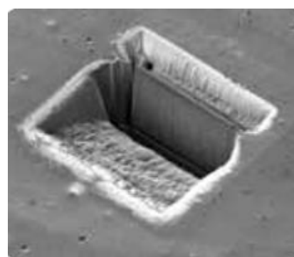
Rys. 4. Przekrój poprzeczny próbki MEMS. Czas pracy: Ga-FIB 40 godzin, Xe-PFIB 1 godzina 20 minut.
