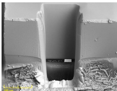
Trawienie dużej objętości matrycy TFT wykonane przy użyciu Plasma FIB [przykładowy obraz]
